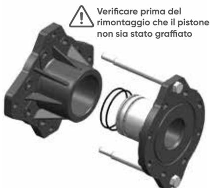
**4** Togliere le viti n°9, sostituire ed ingrassare le guarnizioni n°8, sigillatura con il corpo (grasso siliconico per contatto alimentare).
