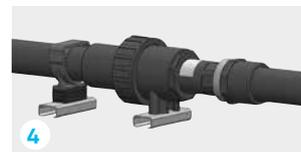
Creare il punto fisso su un supporto rigido all'altra estremità della lunghezza e rimuovere l'indicatore di installazione. La posa dell'isolamento termico deve essere eseguito in conformità al D.P.R. 412/91. Non incollare l'isolante termico sulla parte mobile in quanto ciò potrebbe ostacolarne il movimento.
