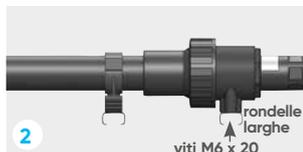
Applicare il polimero di saldatura senza eccessi sull'intero codolo femmina dell'HCOMP e sul tubo, procedere al montaggio quindi bloccare l'insieme utilizzando gli inserti M6.
