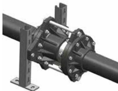
**7** Terminare il montaggio delle basi al compensatore con le viti (N°4) con coppia di serraggio 40 Nm.
