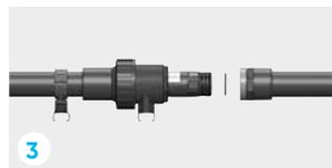
Individuare la lunghezza del tubo da compensare. Saldare il manicotto filettato sul tubo quindi collegare il gruppo alla parte mobile utilizzando la guarnizione piatta. Utilizzare pasta di silicone flessibile o nastro in PTFE. Sono vietate resine anaerobiche e stoppe. L'avvitamento sarà fatto a mano, solo l'ultimo 1/4 di giro sarà fatto con la chiave inglese, cinghia o ruota, le chiavi ad artiglio sono vietate.
