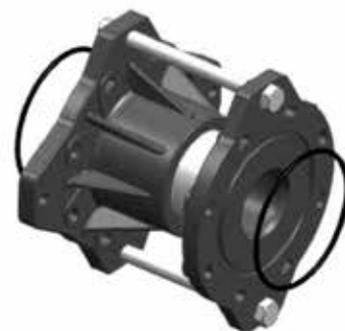
**3** Sostituire e ingrassare le guarnizioni n°2, sigillatura con le basi da incollare (grasso siliconico per il contatto alimentare).
