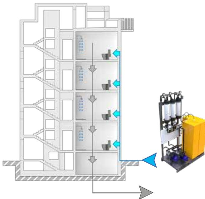
utilizza membrane ad ultrafiltrazione (che consente di rimuovere batteri e virus).
