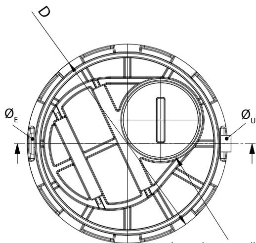
ispezione sedimentazione e prelievo fanghi
