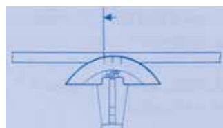
Fase 2 - Porre il tubo nella pinza curvatubi.
