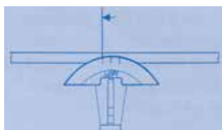
Fase 2 - Porre il tubo nella pinza curvatubi.
