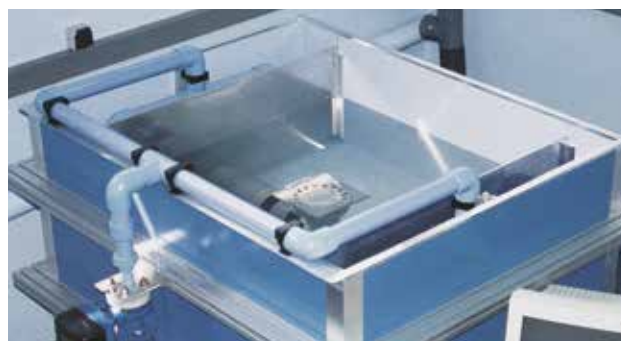
Prova di evacuazione su un chiusino sifonato.
