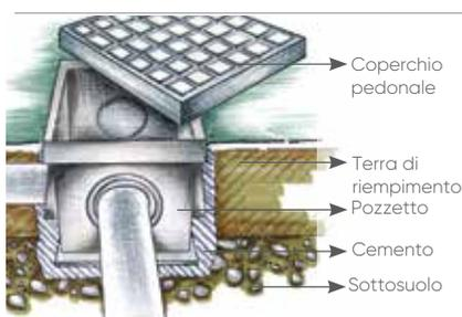
Materiale: PVC. Utilizzo: Chiusura di pozzetti di ispezione. Installazione: il coperchio è adatto al pozzetto Redi. Per la chiusura di pozzetti in cemento o per casi particolari si raccomanda la posa della versione con telaio.
