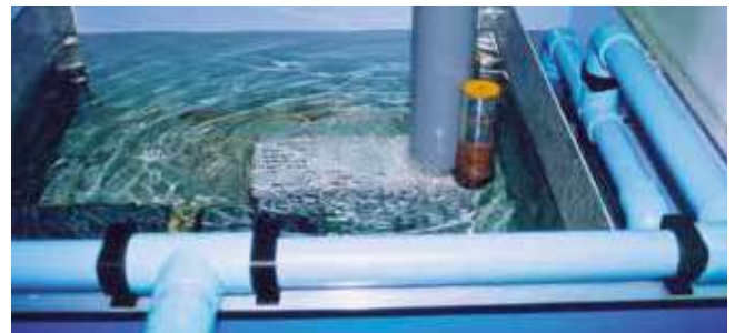
Prova di evacuazione su un pozzetto pluviale.
