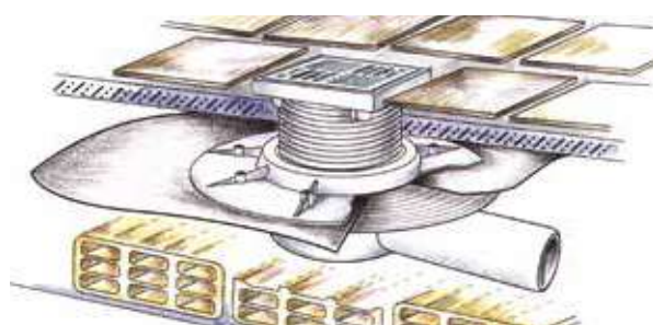
esempio di installazione con membrana impermeabilizzante
