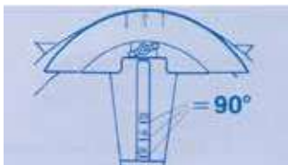
Fase 3 - Azionare la leva della pinza fino ad ottenere l'angolazione voluta.
