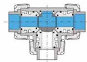
\* Se la configurazione non viene specificata, la valvola con sfera a T verrà fornita standard in configurazione 1.
