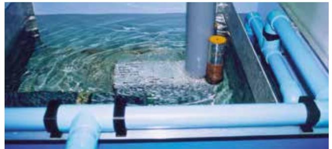
Prova di evacuazione su un pozzetto pluviale.
