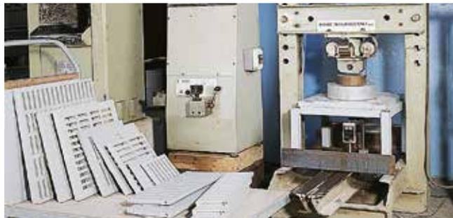
Prova di rottura su una griglia pesante.
