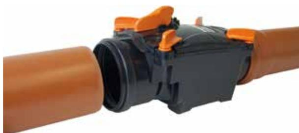
Esempio di installazione con tubi ad innesto con guarnizione si raccomanda di smussare e lubrificare il tubo prima dell'innesto
