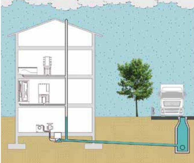
In caso di sovraccarico delle fognature, spesso si rischia l'allagamento di garage, cantine e locali seminterrati. Installare una valvola antiriflusso protegge l'abitazione dal ritorno delle acque dalla fognatura ed evita danni economicamente rilevanti, a cui il proprietario della casa deve far fronte personalmente.
