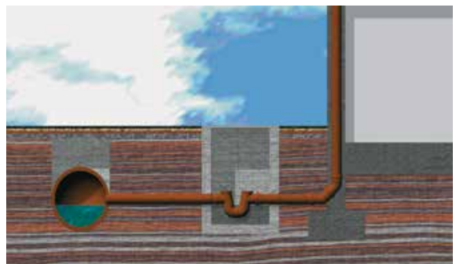
Esempio di installazione di sifoni AN in un pozzetto di cemento esternamente all'abitazione e prima del collegamento al collettore principale.
