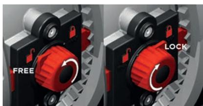
Ruotando il pulsante verso sinistra e orientando la freccia sul lucchetto aperto si mette il DUAL BLOCK® in posizione di sblocco: le ghiera della valvola sono libere di ruotare in senso orario ed antiorario. Ruotando il pulsante verso destra e orientando la freccia sul lucchetto chiuso si mette il DUAL BLOCK® in posizione di blocco: le ghiera della valvola sono bloccate in una posizione prefissata.
