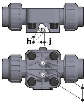
Tutte le valvole, sia manuali che motorizzate, necessitano in molte applicazioni di essere adeguatamente supportate.
