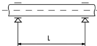
L'installazione dei tubi in materiale termoplastico richiede l'utilizzo di supporti per prevenire flessioni e conseguenti stress meccanici. La distanza tra i supporti è connessa a materiale, SDR, temperatura superficiale della tubazione e alla densità del fluido convogliato. Prima di procedere all'installazione dei supporti verificare le distanze riportate nella tabella seguente, in accordo alla linea guida DVS 2210-01 per tubazioni per convogliamento acqua.
