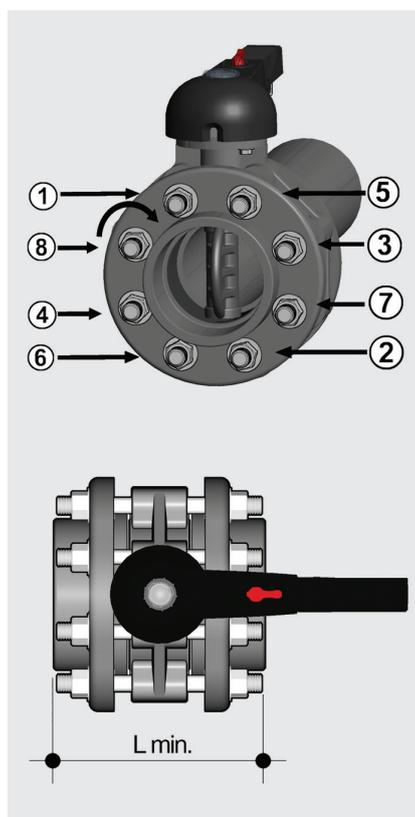
Prima di effettuare il serraggio dei tiranti, si consiglia di aprire la lente, per non danneggiare la guarnizione. Serrare in modo omogeneo i tiranti di collegamento seguendo l'ordine numerico indicato in figura, secondo la coppia nominale indicata in tabella. Non occorre forzare il serraggio dei tiranti per ottenere una perfetta tenuta idraulica. Un eccessivo serraggio pregiudicherebbe il contenimento delle coppie di manovra della valvola.
