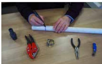
Tracciare un anello intorno al tubo flessibile in un punto situato a circa 2 - 2 ½ volte la profondità del raccordo. Segnare 4 punti intorno al tubo flessibile dove inciderlo.
