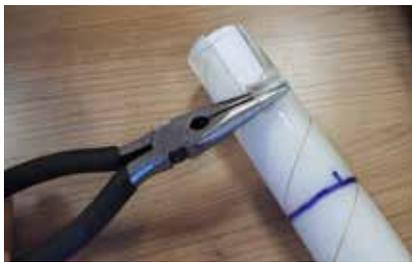
Utilizzando delle pinze a becchi lunghi, afferrare l'estremità e arrotolare a ritroso il PU fino al segno. Ripetere l'operazione fino a quando tutta la parte esterna non è stata sollevata.
