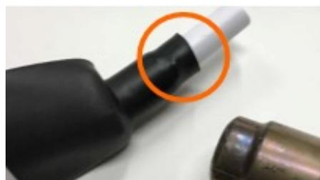
Ispezionare il collante esposto nel punto in cui il tubo termorestringente nero e il tubo interno si uniscono. Questa piccola goccia di adesivo esposto assicura la tenuta. Lasciare raffreddare completamente.
