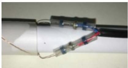
Fare scorrere i fili del cavo principale nella guaina di saldatura (senza polarità).
