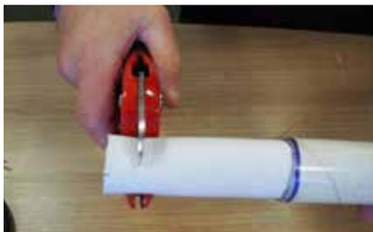
Rifilare con cura l'estremità del tubo flessibile nel punto in cui si è effettuato il taglio, in modo da garantire che non vi sia alcun danno all'estremità del tubo stesso.
