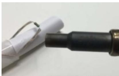
Riscaldare le guaine fino a quando non si sono ristrette completamente e gli anelli di saldatura non si sono fusi diventando fluidi. Continuare a muovere la fonte di calore per evitare fenomeni di carbonizzazione. Non muovere il collegamento fino a quando non si è raffreddato, poiché in caso contrario può indebolirsi.
