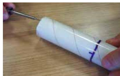
Utilizzando un piccolo cacciavite, sollevare l'estremità del rivestimento esterno in PU.
