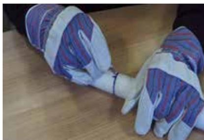
Utilizzando un taglierino cutter affilato, incidere il rivestimento esterno in PU fino a una profondità di circa 0,5 mm (per evitare di danneggiare il tubo flessibile interno). A 10 mm dall'estremità del tubo flessibile, inciderlo a fondo. Ripetere l'operazione in corrispondenza di ciascun segno.
