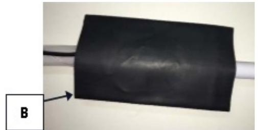
Inserire il tubo flessibile nel tubo termorestringente (B), assicurandosi che questo copra l'estremità della resistenza e tutti i fili del sensore esposti.
