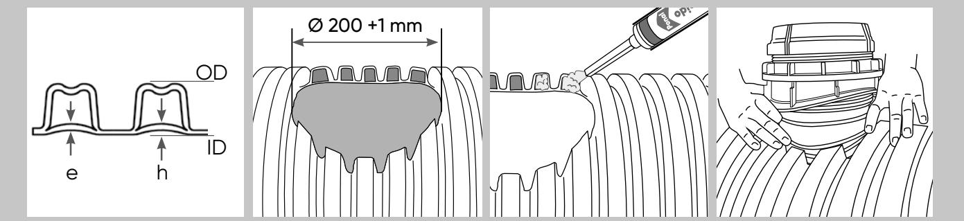
**1** Il foro deve essere eseguito con attrezzature adeguate al materiale da perforare e perpendicolarmente alla mezzeria del tubo in modo da evitare ovalizzazioni e/o eccentricità che potrebbero compromettere la tenuta idraulica di Easy Clip.
