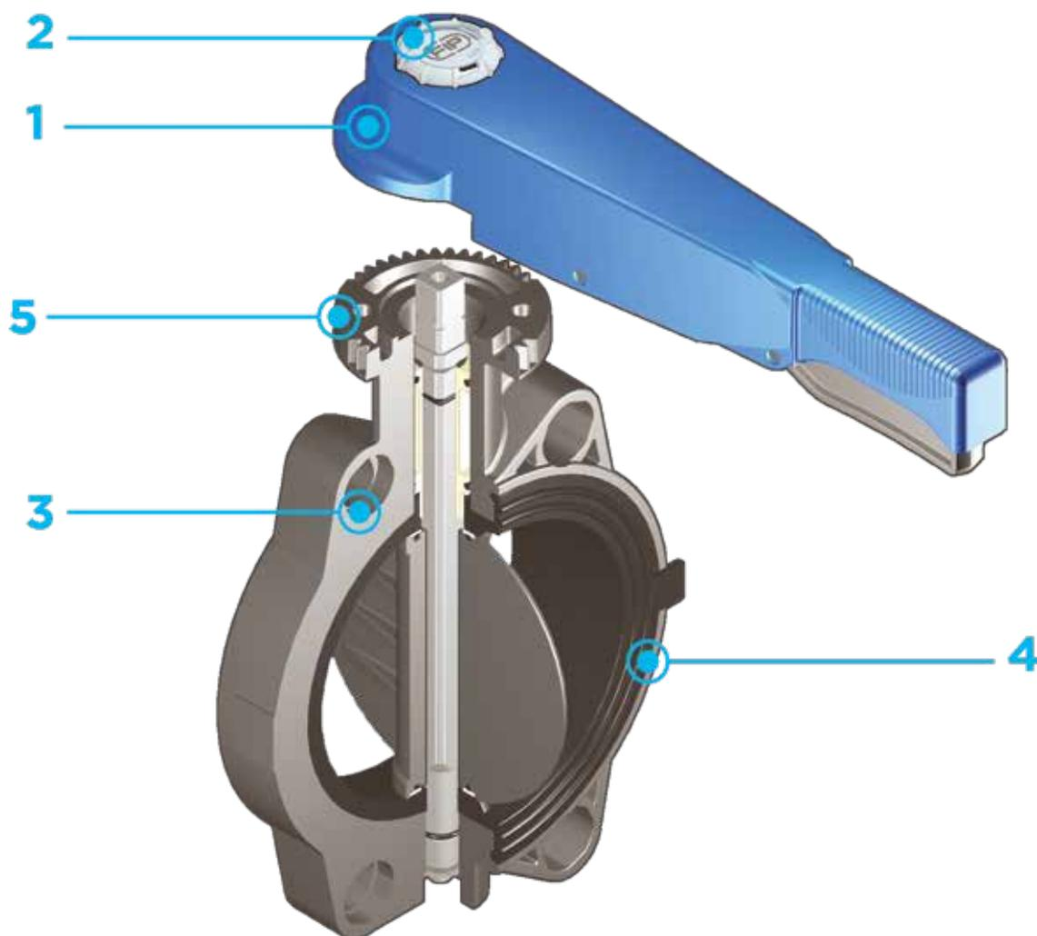
**1** **Maniglia multifunzione** ergonomica in HIPVC con possibilità di **manovra rapida**, **regolazione graduata** in 12 posizioni (ogni 7,5°). Montaggio reversibile su 180°
