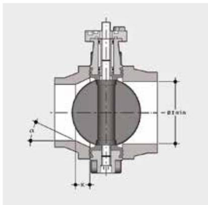
Prima di procedere all'installazione dei raccordi flangiati di collegamento, verificare che la luce libera di passaggio dei raccordi stessi permetta la corretta apertura della lente della valvola. Controllare inoltre la quota massima di accoppiamento per la guarnizione primaria. Prima di effettuare l'installazione della valvola FE è opportuno verificare che il diametro di passaggio della cartella consenta la corretta apertura del disco.
